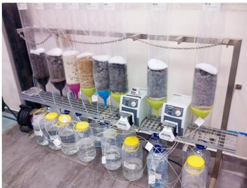
Fig 2. Sistema de columnas de lixiviación múltiples montado por AGQ Labs
